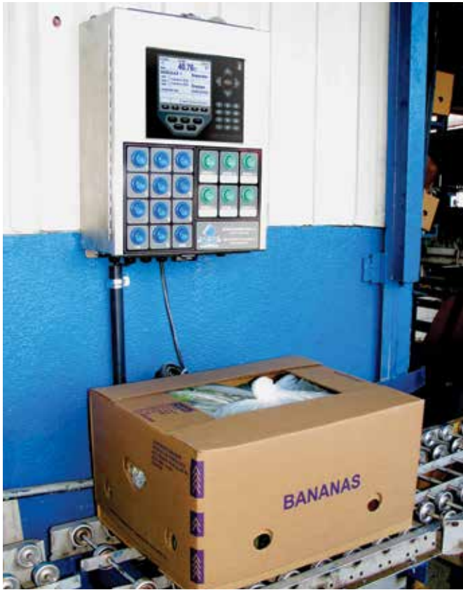
El verificador de peso BANACHECK de Rep. Roma emplea botones extra grandes para pasar fácilmente de una categoría a otra del producto.
