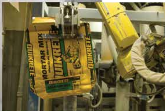
Izquierda: Las bolsas de QUIKRETE experimentan un proceso de llenado totalmente automatizado.
