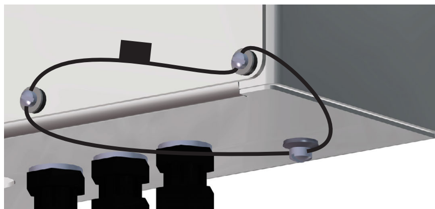
Abbildung 2-30. Versiegeln eines Geräts mit Universal-Montagehalterung
