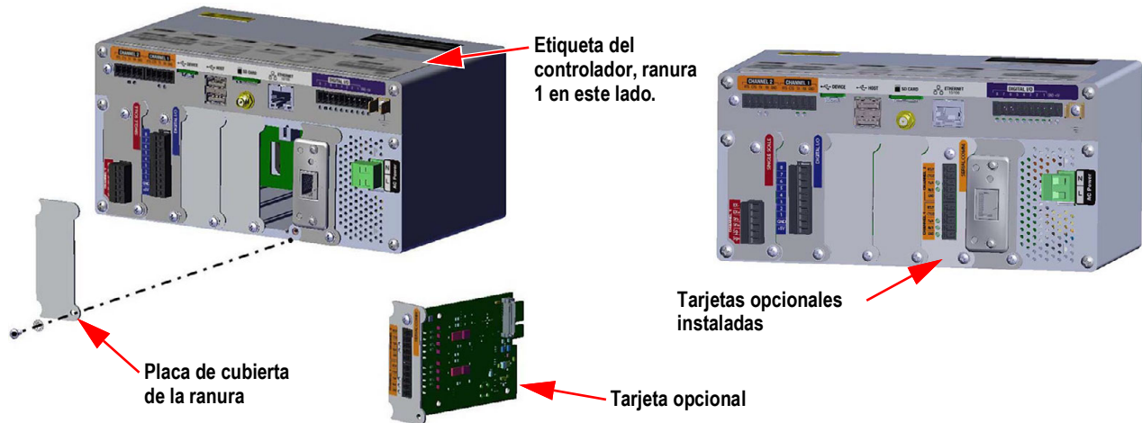
Figura 2-24. Instalación de la tarjeta opcional
