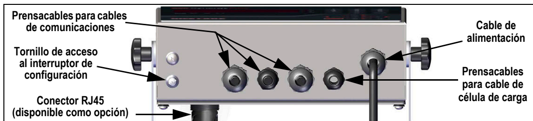
Figura 2-5. Asignación recomendada para los prensacables
