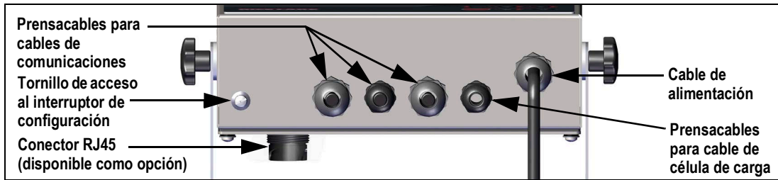
Figura 2-5. Asignación recomendada para los prensacables
