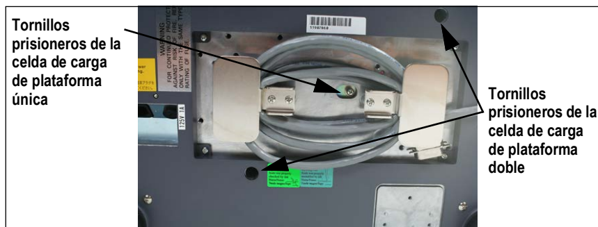
Figura 2-2. Ubicación de los tornillos prisioneros de la celda de carga para básculas de plataforma única y doble (se muestra la base de báscula DIGI S-XL)
