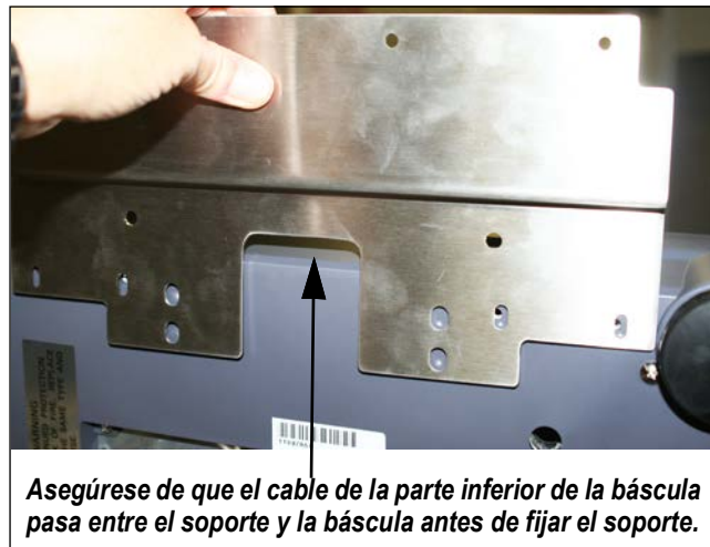
Figura 2-18. Fije el conjunto del soporte a la base de la báscula mientras esta está inclinada sobre un lado (se muestra la base DIGI S-XL)
