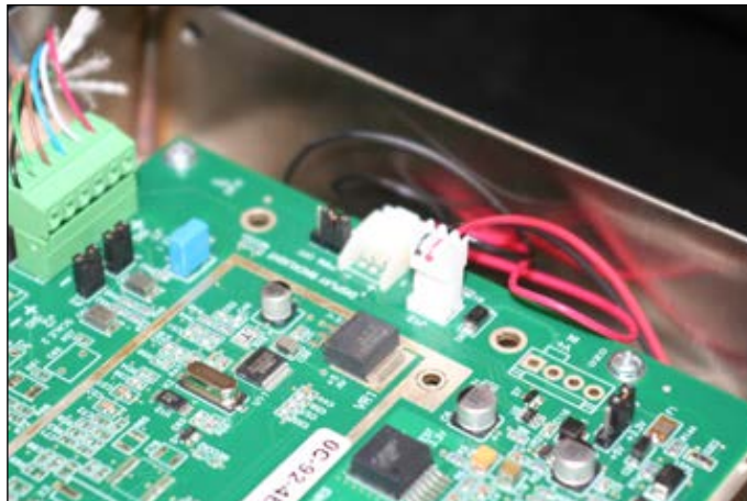
Figura 2-14. Conecte el enchufe de alimentación en J12 de la placa de CPU
