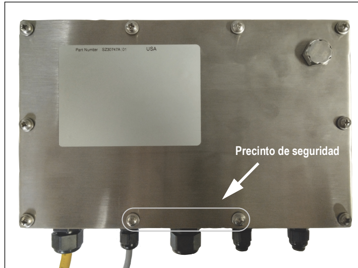
Figura 2-7. Método de precintado de dos puntos
