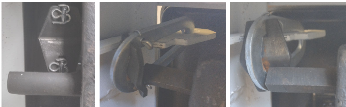
Figura 4-3. Posiciones incorrectas de pivotes y cojinetes
