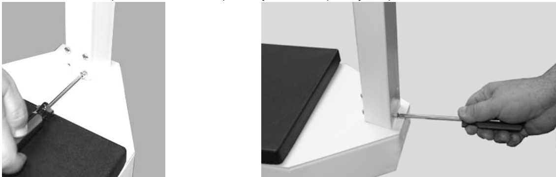
Figura 2-4. Coloque ocho pernos y arandelas para fijar el pilar a la base de la báscula
