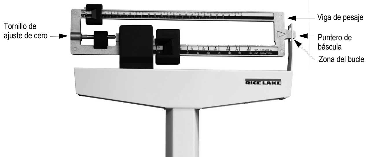
Figura 3-1. Zona del bucle y posición del tornillo de ajuste de cero (se muestra la versión en lb y kg sin barra de altura)
