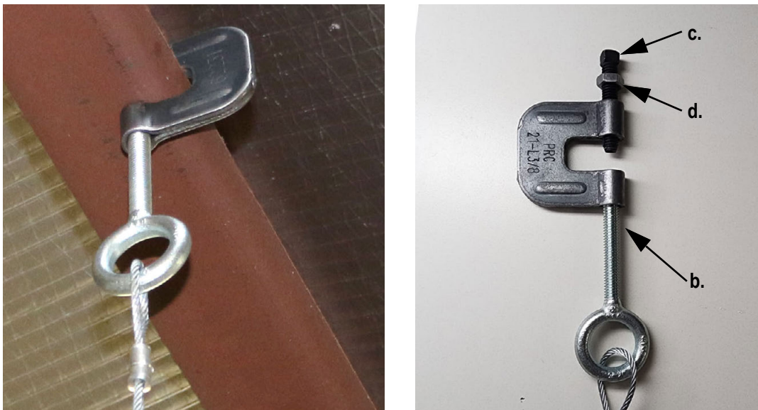
Illustration 3. Fixation du serre-joint de la poutre à la structure du toit
