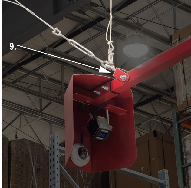
Illustration 6. Assemblage des tendeurs à la suspension
