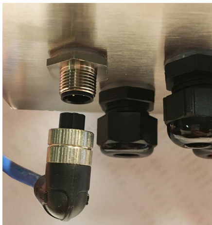
Illustration 3. Raccordement des câbles à l'indicateur 882IS
