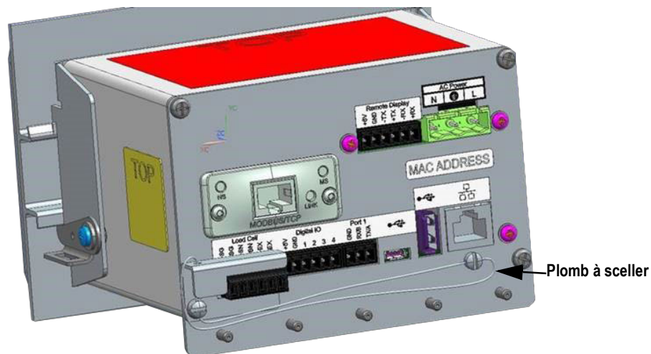
Illustration 2-29. Installation du plomb à sceller
