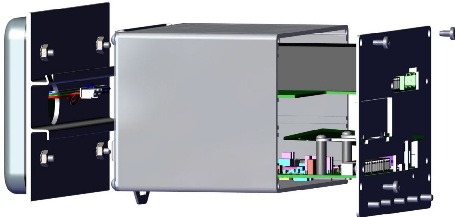
Illustration 2-9. Dépose de la plaque arrière du contrôleur
