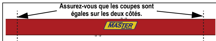
Illustration 2-7. Redimensionnez la barre peseuse - Modèle 311M uniquement
