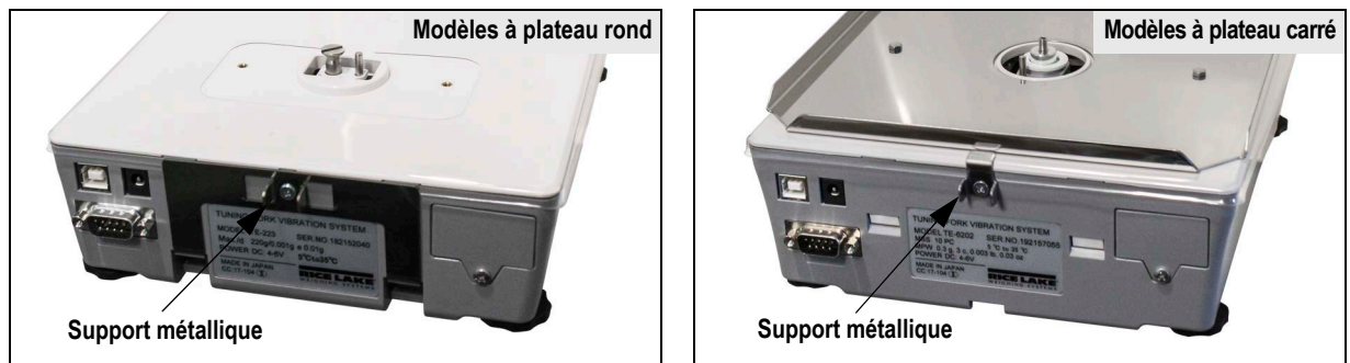
Figure 5-7. Positionnement du support métallique
