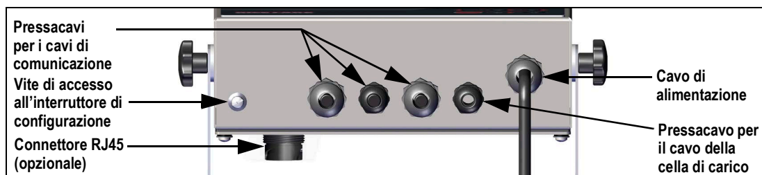
Figura 2-5. Posizioni raccomandate per i pressacavi
