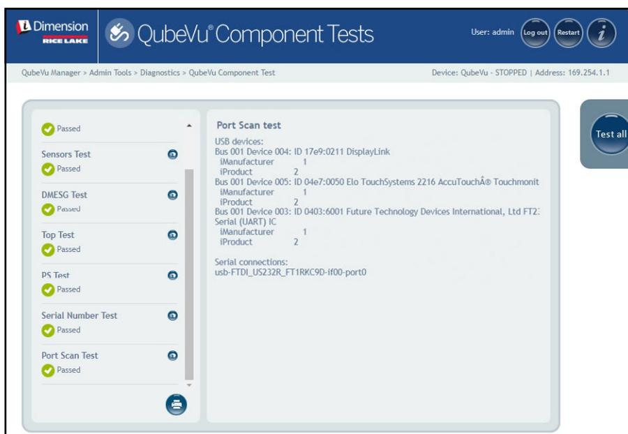
Figura 10-6. Port ScanTest (Test di scansione porte)
