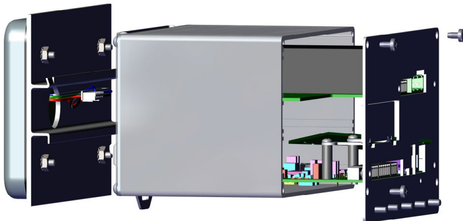
Figura 2-9. Rimozione della piastra posteriore del gruppo controller
