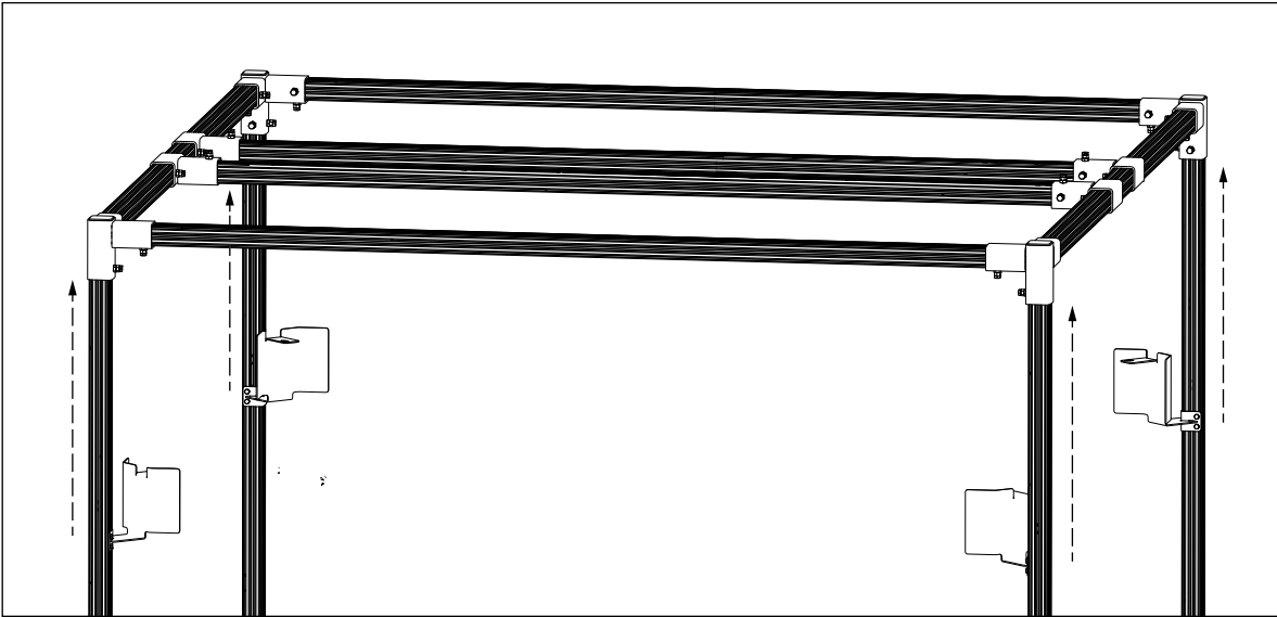
Figura 3-14. Fissaggio del gruppo sensori IFM remoti
