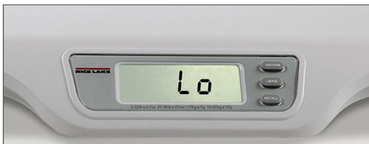
Figura 2-2. Indicador de carga baja de batería
