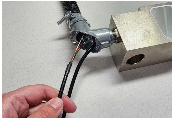
Figura 4-4. Instalación del racor de 90° en la célula de carga
