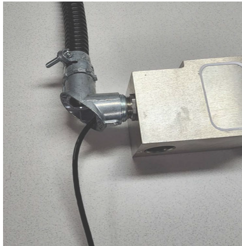
Figura 4-3. Instalación del racor de 90° en la célula de carga
