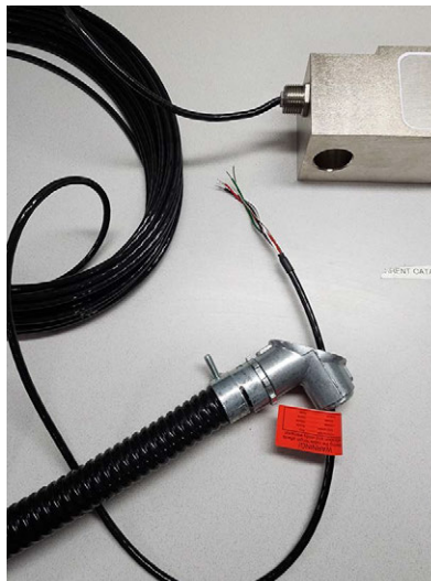
Figura 4-2. Insertar el cable de la célula de carga a través del orificio del racor de 90°
