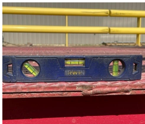
Figura 3-8. Compruebe que la báscula puente está nivelada
