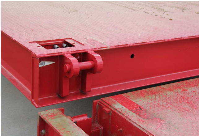
Figura 3-6. Conexión de conector y receptáculo
