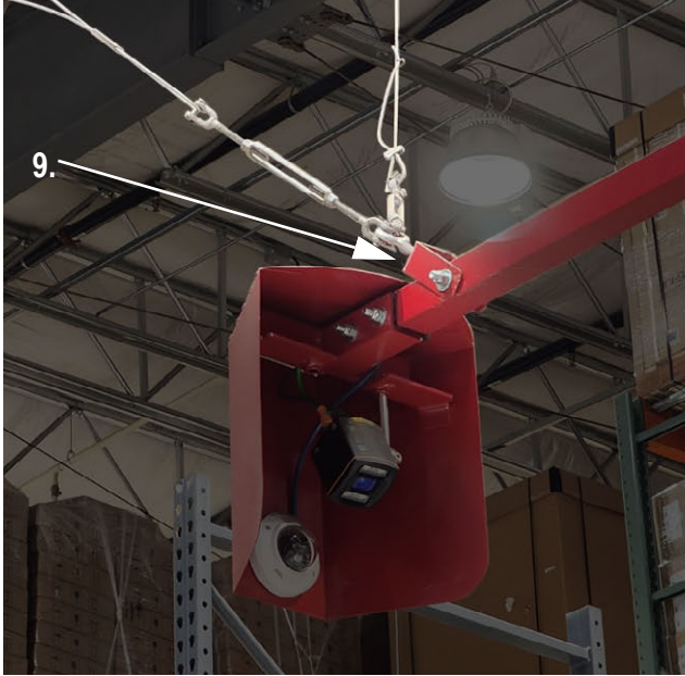
Afbeelding 6. Spanschroeven tot hangerconstructie
