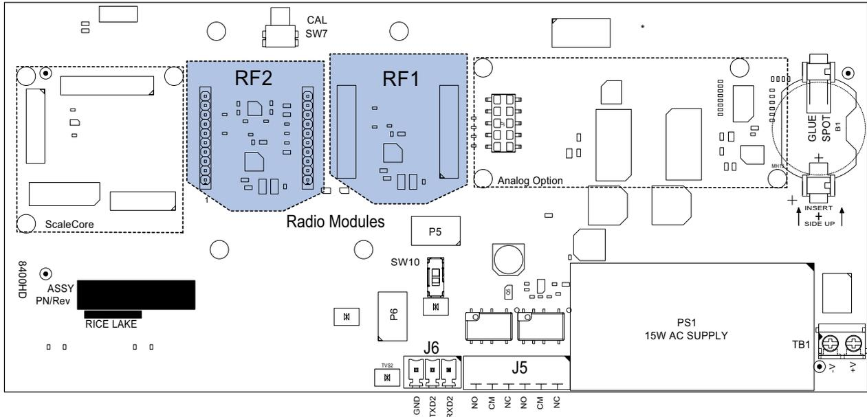
Figure 2-6. radio module
